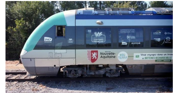
Kuva 19. Alstom ACG Batterie akkukalusto. Lähde: Alstom.
